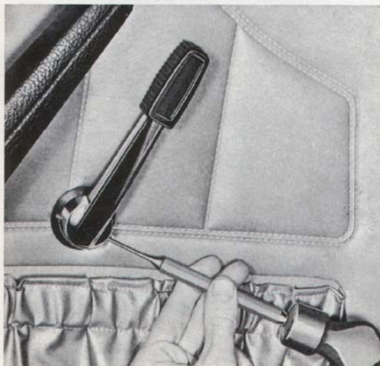
Bild 8-4. Demontering av dörröppnare
