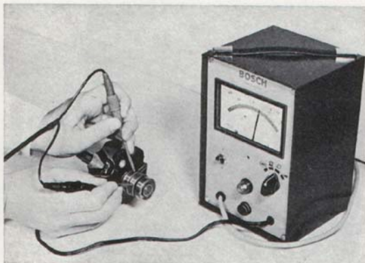
Bild 3-38. Kontroll av rotorns resistans
