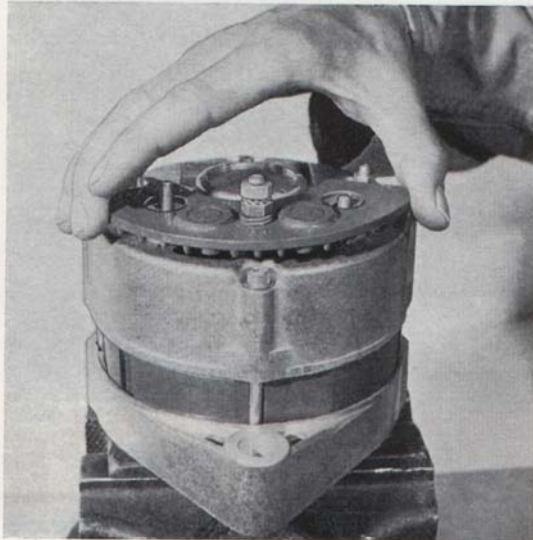
Bild 3-5. Demontering av skyddsdiöd
