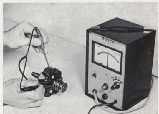
Bild 3-37. Kontroll av rotorns isolering
