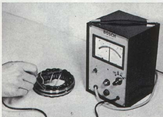
Bild 3-35. Kontroll av statorns isolering
