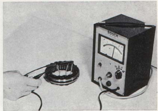
Bild 3-36. Kontroll av statorns resistans
