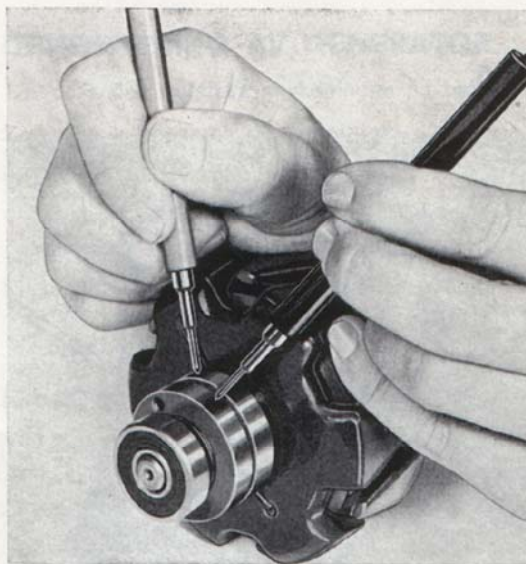
Bild 3—11. Kontrollmätning av rotorn
