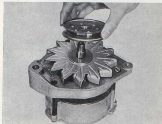
Bild 3—29. Demontering av remskiva
